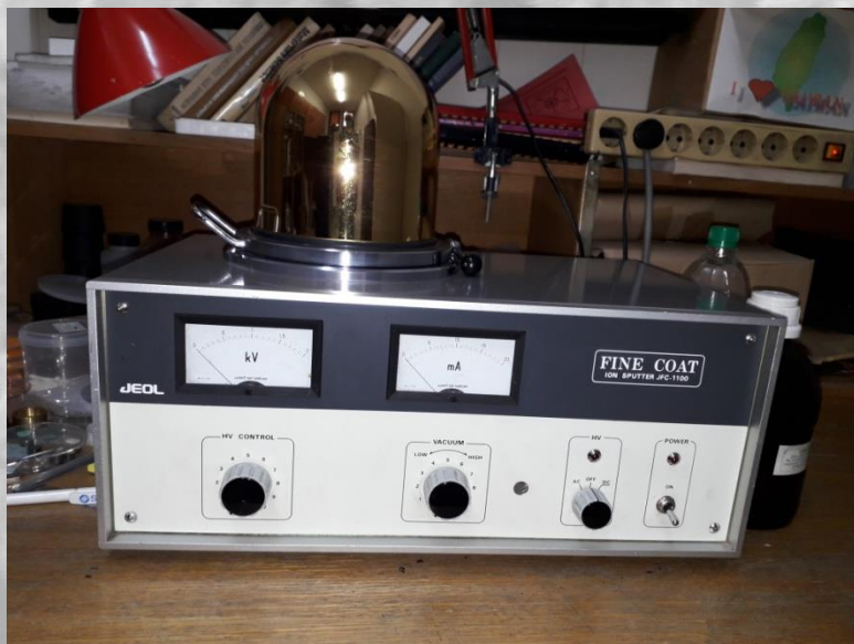
Уређај за прекривање узорака проводним слојем
