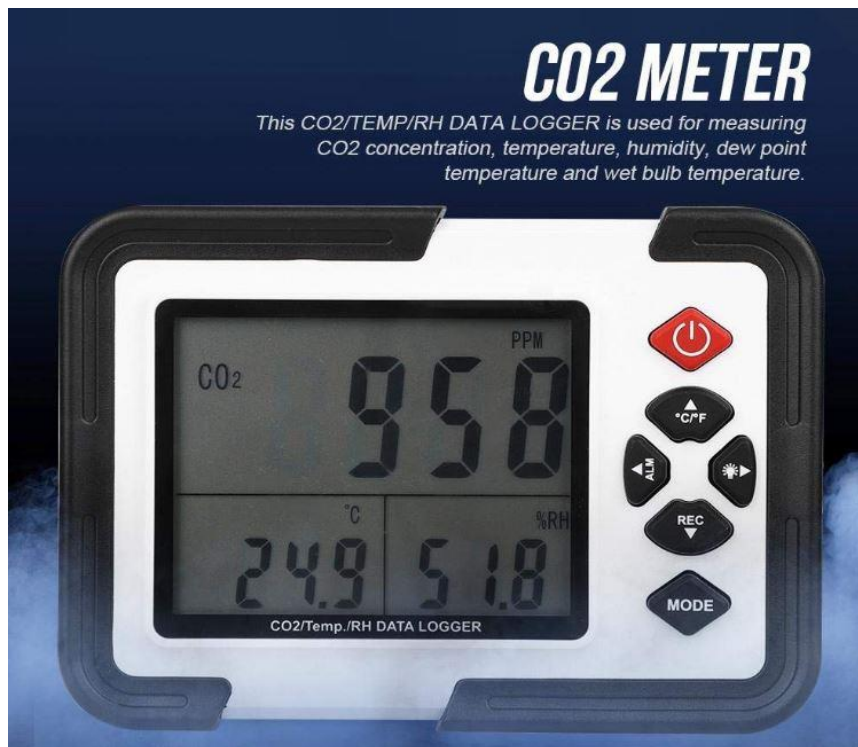
Prilog 6. Data logger za merenje temperature, koncentracije CO 2 i vlažnosti vazduha
