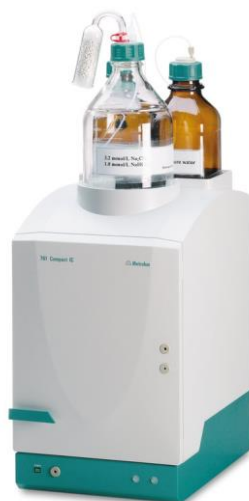
Слика 4.3.1. Изглед уређаја Metrohm 761 Compact IC коришћеног у анализи јонског састава узорака PM_{10}
